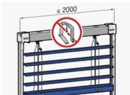
Die selbsttragende Storeskonstruktion schont die Isolation im Sturz und reduziert Servicekosten. Bis zu einer Breite von 2000 mm kommt das System ohne Befestigung für den Tragkanal aus – die Isolation bleibt intakt und die Geräuschübertragung wird reduziert.
